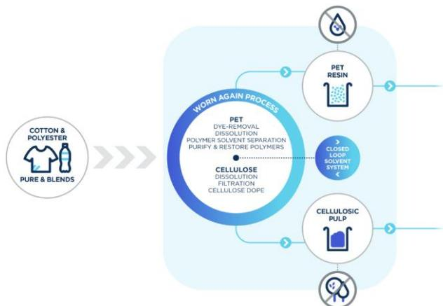
**Planta Piloto** - Se extrae el poliéster (PET) y la celulosa de los residuos textiles polycotton no reutilizables para producir doblemente PET y celulosa.
