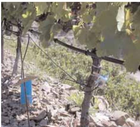
Dendrómetro y sensor de humedad del suelo
