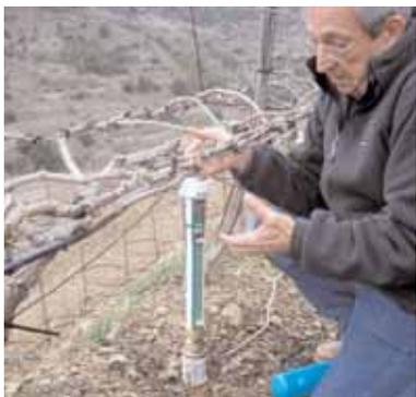
Sensores para medir la humedad del suelo a tres profundidades: 35 cm, 50 cm y 70 cm
