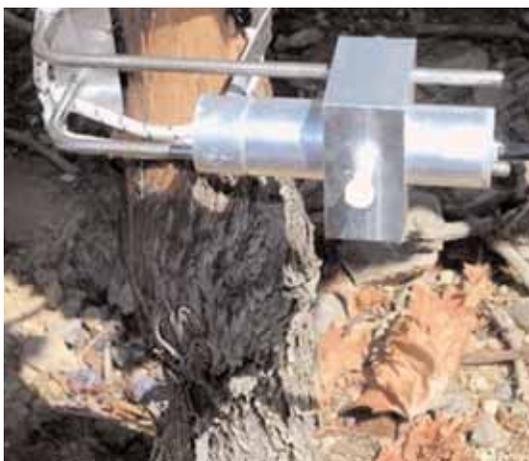
Dendrómetros (para medir las variaciones del diámetro del tronco de la cepa)
